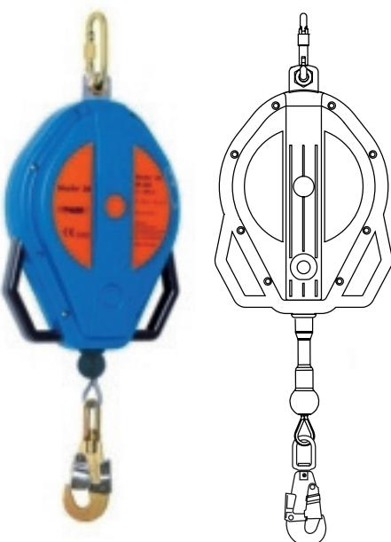
La gamme Blocfor™ assure une fonction de blocage automatique en cas de chute ; la hauteur de chute est limitée par la réaction immédiate du frein. La longueur du câble est ajustée automatiquement grâce à un système de rappel intégré à l'appareil, ce qui permet à l'utilisateur une grande liberté de mouvements.
